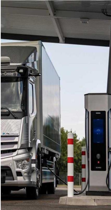
Veicoli di trasporto merci pesanti (M/HDV) elettrici hanno batteria di dimensioni paragonabili a ~9 auto EV<sup>3</sup>. Potenze di ricarica da 150 - 350kW (e oltre) abilitano la ricarica stradale<sup>4</sup>
